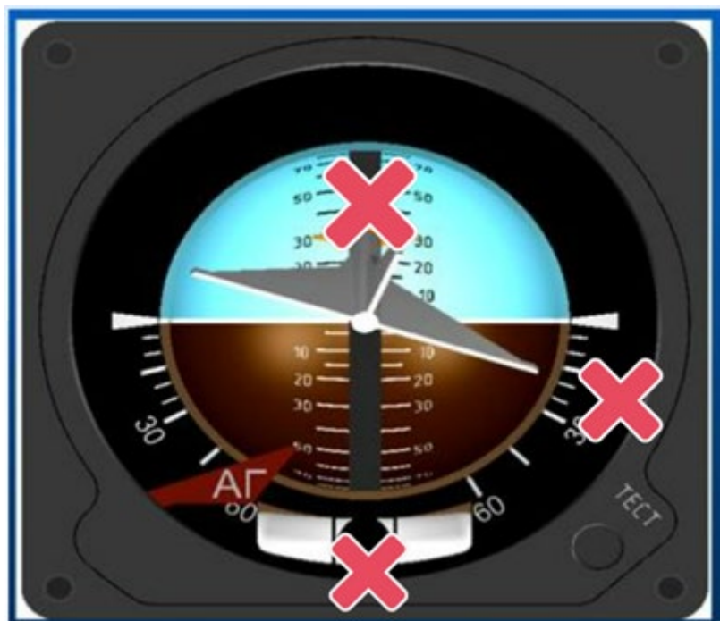
Рисунок 5. авиагоризонт обратной индикации
